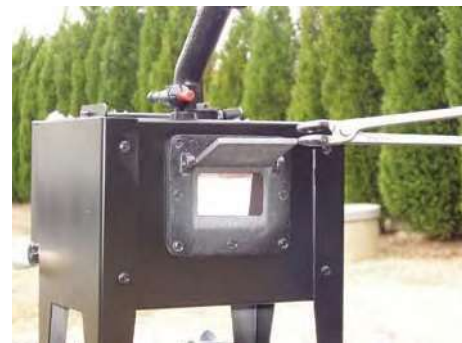
リア・バー・ストック(後部小窓)が 鉄幹の直刺しを可能にします 背面小窓: W76mm×H38mm
